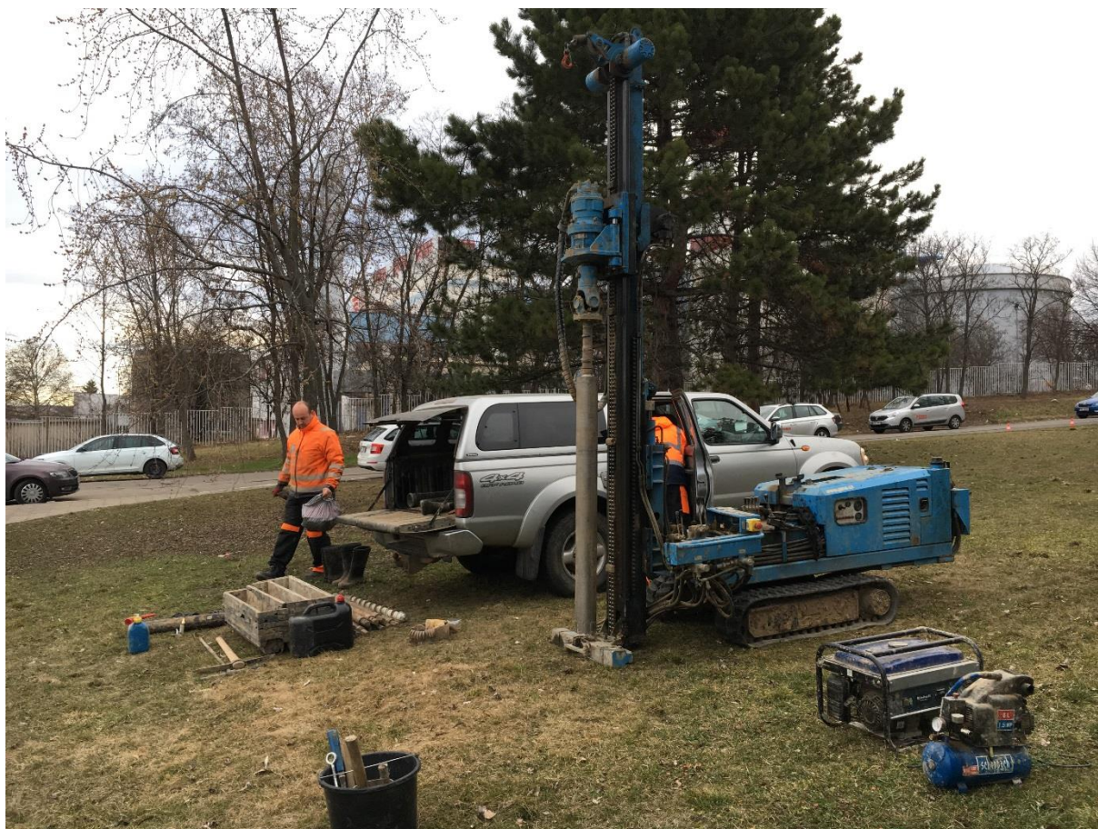
Foto č.3: Vrtné práce, sonda JV1
